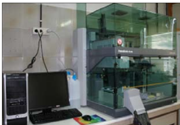
FIG.1 PIATTAFORMA ROBOTIZZATA PER IL PROCESSAMENTO DI TESSUTI VEGETALI (SX) E TERMOCICLATORE REAL TIME (DX).
