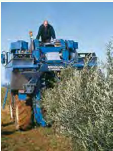
L'asse centrale è utilizzato per impianti superintensivi progettati per la raccolta meccanica in continuo con macchine scavallatrici e per meccanizzare la potatura
