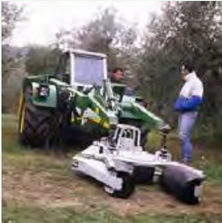
Vibratore di tronco con due masse eccentriche mosse da un solo motore
