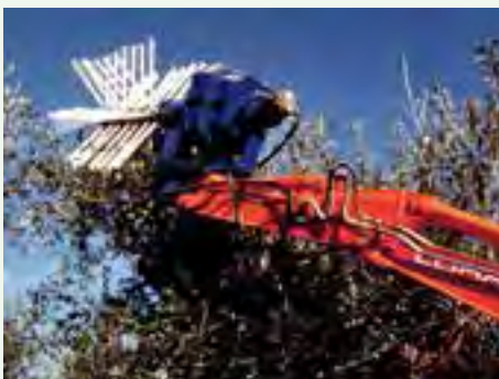
Cantiere di raccolta realizzato nel 1997 dal DIAF: aspo pettinatore montato sul braccio dell'escavatore e minicingolato con telo ad apertura semiautomatica e sistema di stoccaggio con agevolatore di caricamento
