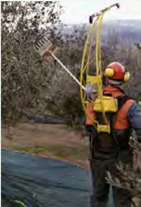
Agevolatore con dispositivo di sostegno per ridurre lo sforzo dell'operatore
