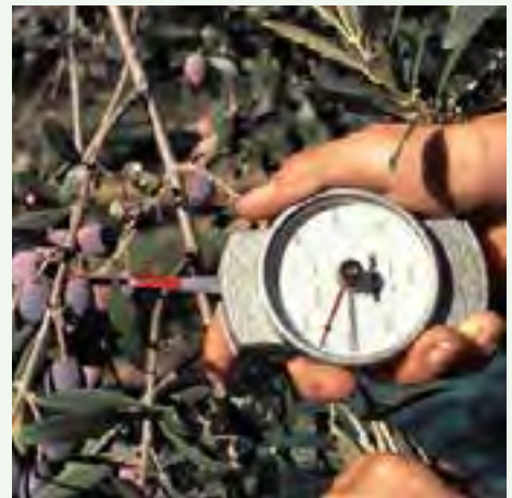
Dinamometro per il rilievo della forza di distacco dei frutti
