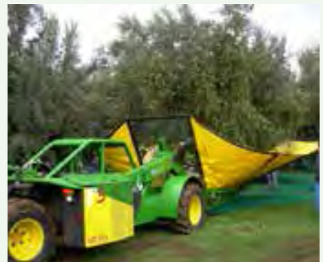
Vibratore di tronco con ombrello rovescio a elevata capacità operativa
