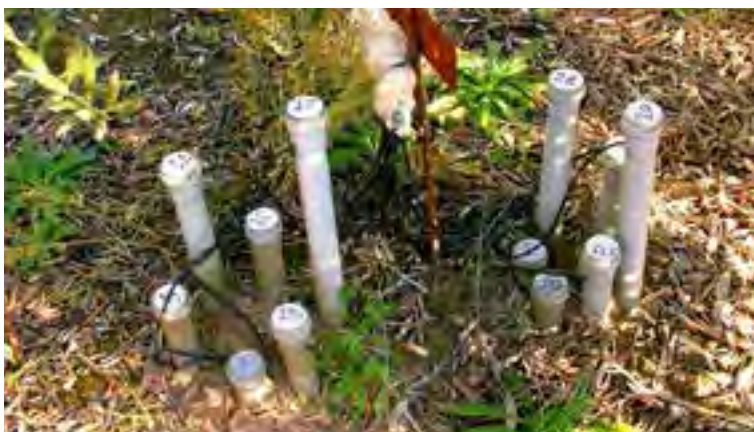
Postazione di sonde TDR per la misura dell'umidità del suolo a diverse profondità
