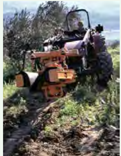
Vibratore di tronco multidirezionale con due motori idraulici contrapposti
