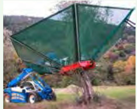
Testata scuotitrice integrata da ombrello rovescio, montati su trattore reversibile
