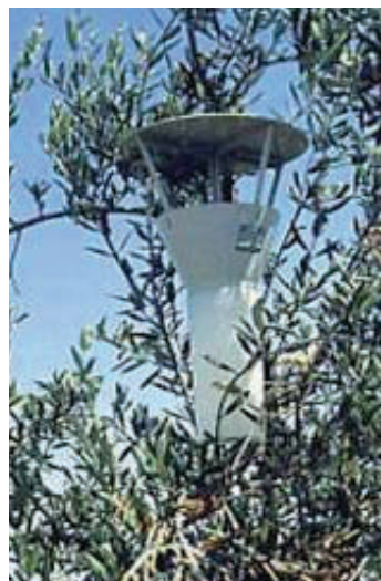
Figura 6: Trappola luminosa per la cattura degli adulti di Z. pyrina (Guario et al., 2002).
