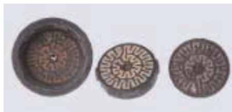
Figura 19. Incrostazioni causate dalla presenza di ferro nell'acqua (da Guidoboni 1990).
