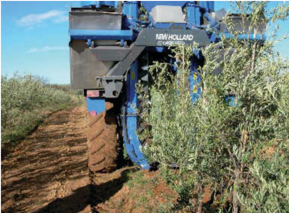
Figura 31. Caratteristiche degli impianti superintensivi e macchina scavallatrice per la raccolta.
