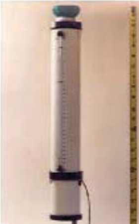
Figura 2. Atmometro (da Altenhofen, 1985).
