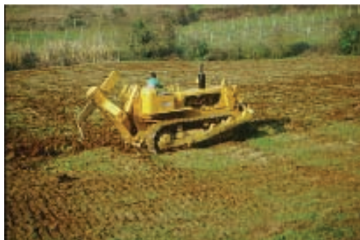
Figura 25. Scasso con ripper.
