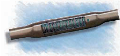
Figura 4. Schema di gocciolatore "in line" (Irritol System Europe s.r.l).
